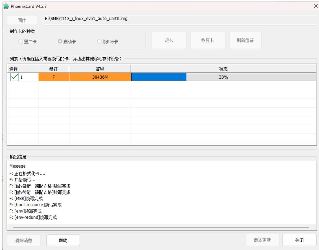
正式烧写完毕后界面如下,可以通过软件界面下方的输出信息查看是否确实制作启动卡成功:
