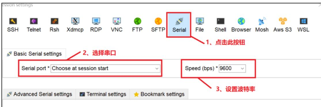
打开串口设置窗口以后先选择要设置的串口号，因此要先用串口线将开发板连接到电脑上，由于 T113-i 默认使用的串口波特率为 115200，需要设置波特率为 115200。
