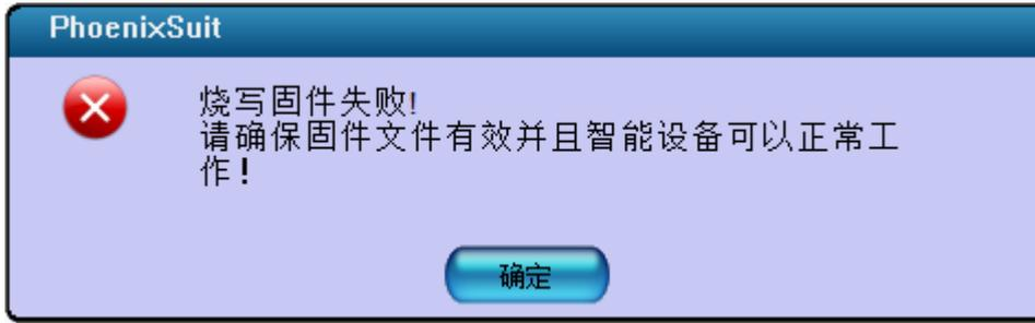
此时请打开串口工具，连接调试串口，查看烧录过程中的报错情况。以下方这种情况为例：
