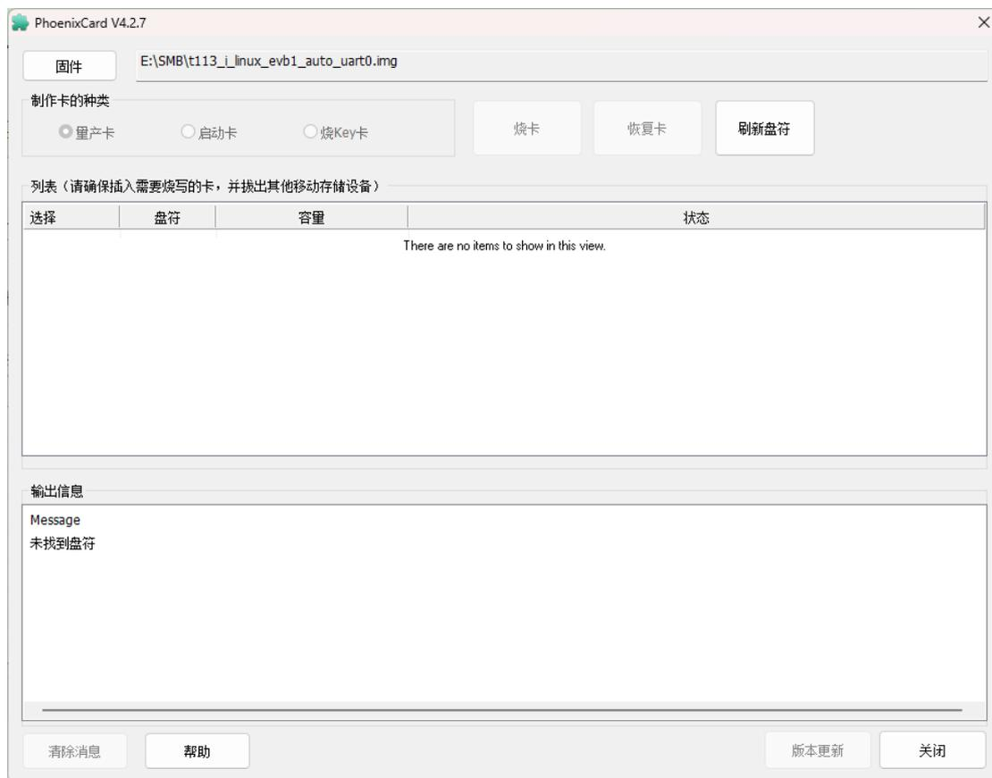
用户请依次选择待烧写固件，选择卡的种类为“启动卡”，而后选择待烧写的 SD 卡设备，该软件会自动扫描可用的移动存储设备，请注意不要选择了错误的设备。最后点击“烧卡”按钮，烧卡过程中会实时显示当前进度：
