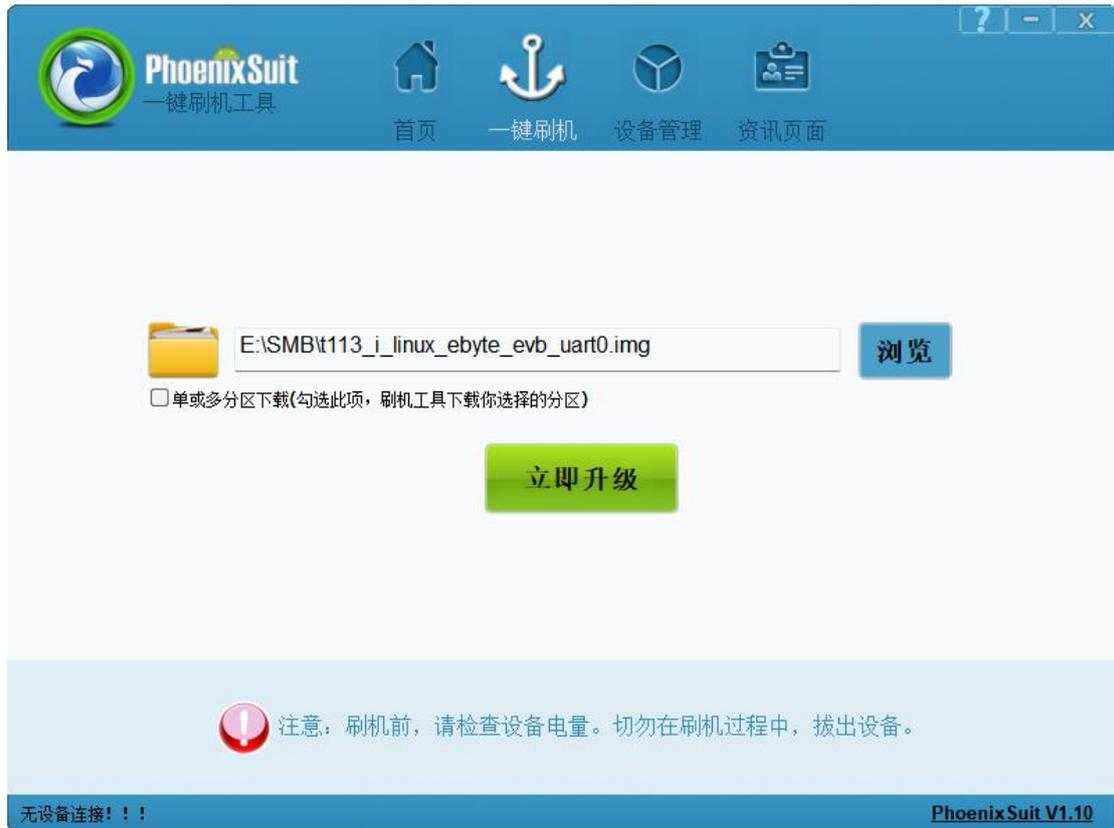
接下来我们连接两根 usb-typec 数据线, 一根用来观察烧写日志, 一根用来烧写板上 flash。连接好之后, 我们需要进入烧写模式。
