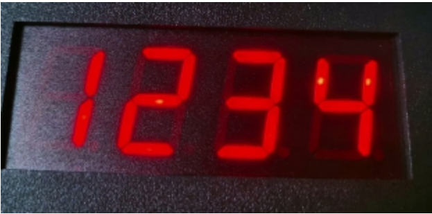
图 4-1-4-1 单寄存器数码管显示示例
