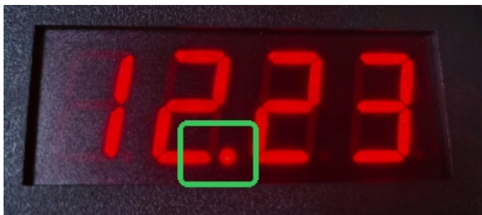
图 4-1-2 数码管显示示例
