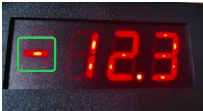
图 4-1-3 数码管显示示例
