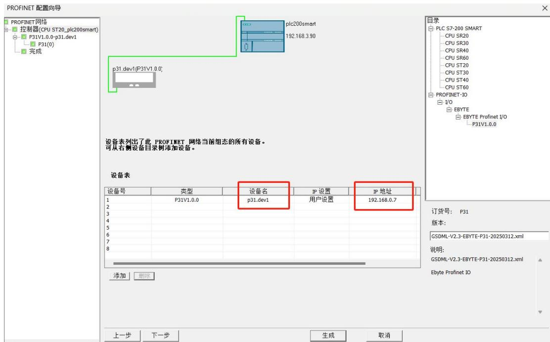
5. 完成相关设置后，点击进入设备视图操作界面。在设备概览区域，将相应的设备型号名（P31-AFAX4440G-U）拖入插槽 1 内。
